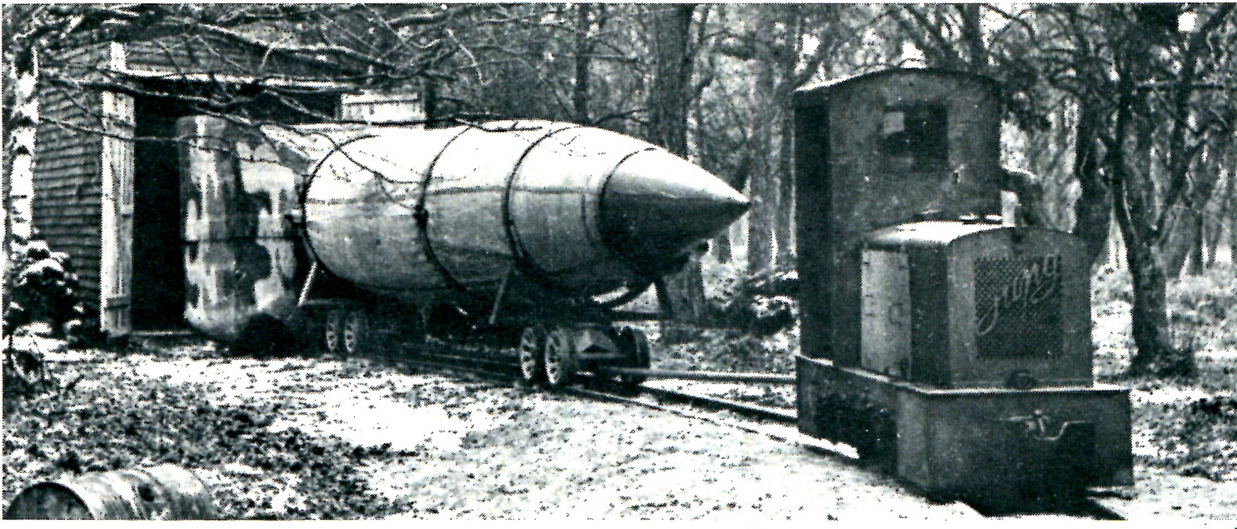
Boven: in Peenemünde werd een A 4-raket met een locomotief uit haar opslagplaats gereden. Op de 'Feldbahn' werd er vervolgens een serie proeven mee genomen.
